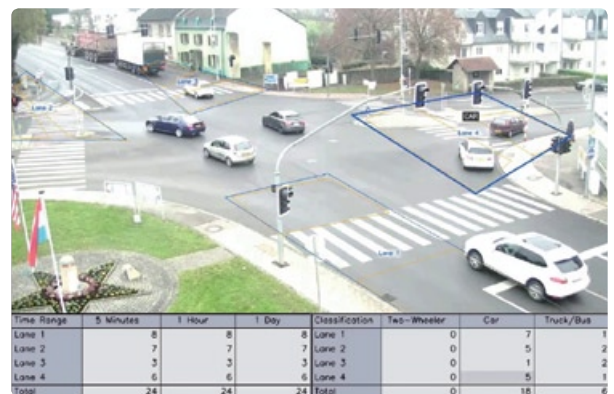
KiwiVision ® Traffic Analyzer mit Auswertung im Videobild
